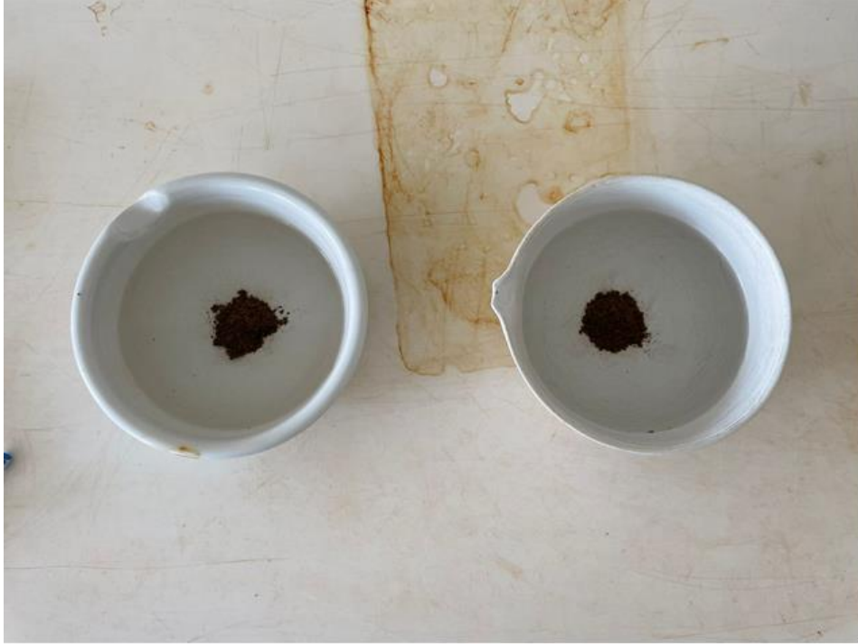
Şekil 9. Günkırı tandır kilinin dağılma deneyi görüntüsü
